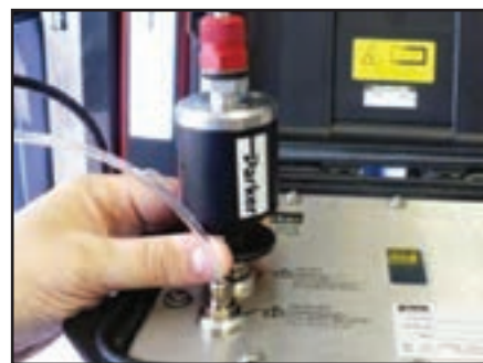
Para remover o PRV, pressione a ferramenta de remoção no mesmo momento da retirada do PRV.
